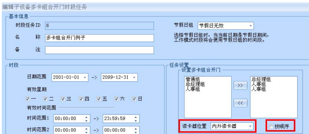
图 10-16 多卡组合开门读卡器位置/顺序刷卡
