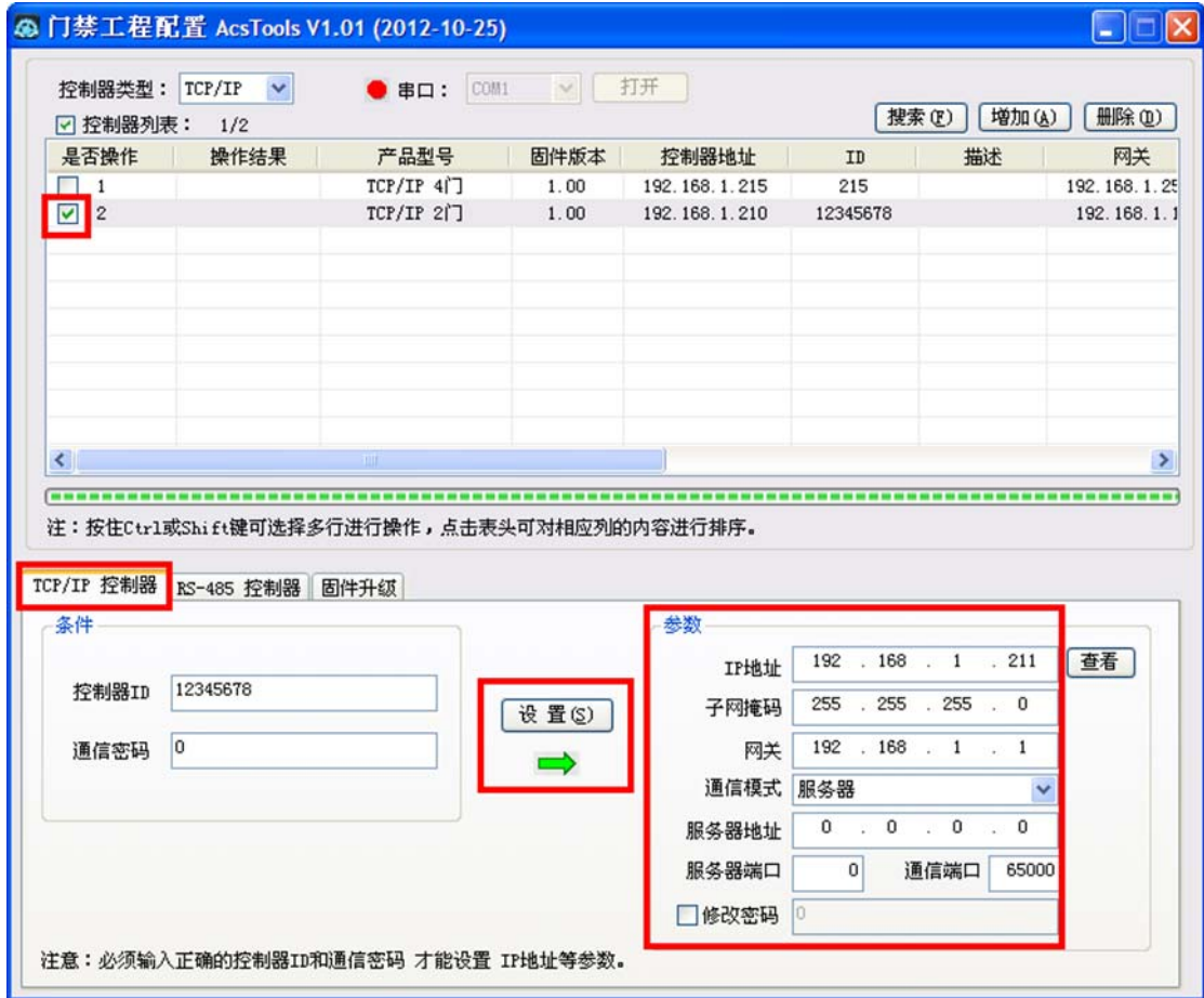
图 4-2 以太网门禁控制器 IP 地址配置
